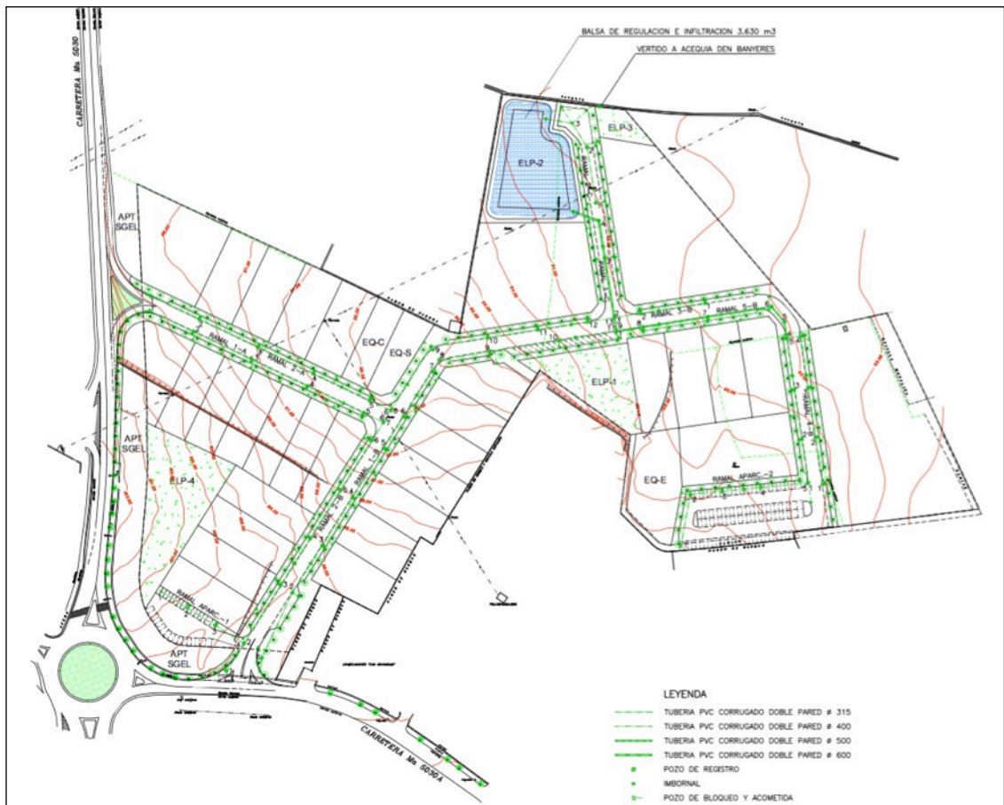
Red de aguas pluviales
